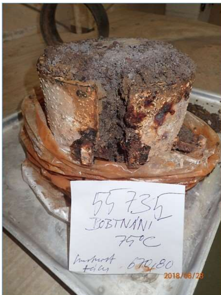
Obr. P5.4: Pohled na vzorek zhutněný 100% energií Proctor standard při teplotě 75 °C po 352 dnech (hypermarket TESCO) a destrukci CBR moždíře
