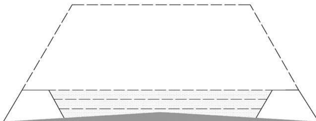
Obr. P1.3: Navezení vrstvy VEP mezi hrázky a zhutnění; vrstva cca 0,30–0,35 m
