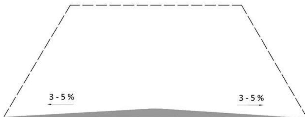
Obr. P1.1: Vyspádování urovnání a přehutnění podloží
